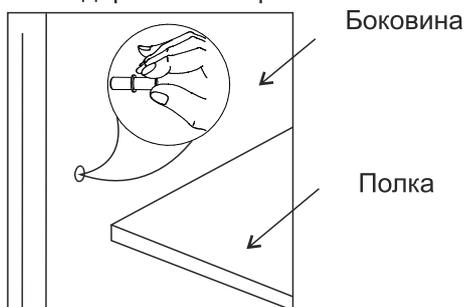
10. Для закрепления задних стенок 23, 24, 25 и 26 необходимо перевернуть собранную конструкцию лицевой стороной вниз. Замерить и уровнять диагональ. Затем приложить детали и выровнять углы. После выверки закрепить ХДФ гвоздями, используя шайбу пластмассовую.
