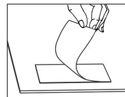
Перед установкой скотча двустороннего следует отчистить приклеиваемые поверхности от пыли и грязи, а также обезжирить (с помощью спирта, растворителя, ацетона и прочих жидкостей).
