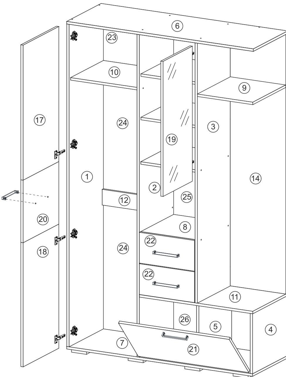
12. На створки 21, 19, а также на ранее собранную створку из деталей 17, 20, 18, установить вкладные петли шурупами 4\*13 мм. Для установки ручек на створки необходимо досверлить глухие отверстия диаметром 5 мм насквозь. Далее закрепить ручки саморезом и навесить створки.
