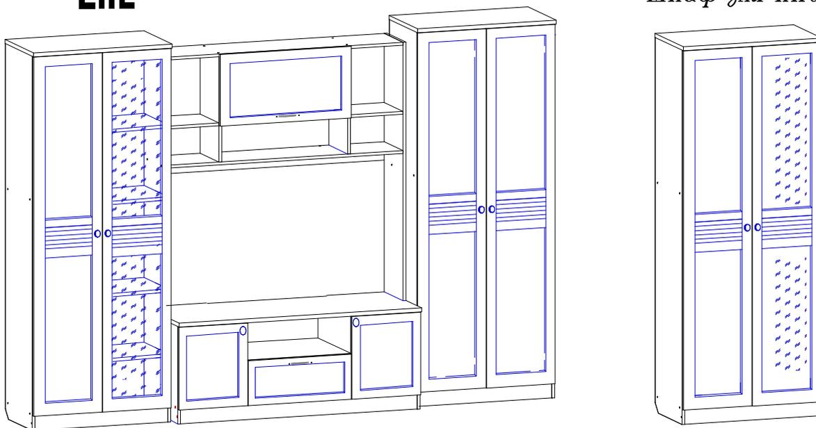
Габаритные размеры: В-2111мм, Г 453мм, Ш-802
