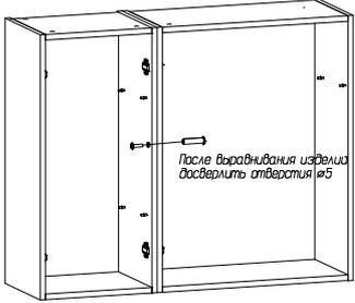
Во избежание опрокидывания шкафа, зафиксируйте его с рядом стоящими шкафами, просверлив самостоятельно отверстия  $\phi 5$  мм в стенках вертикальных и скрепив их между собой стяжкой межсекционной.
