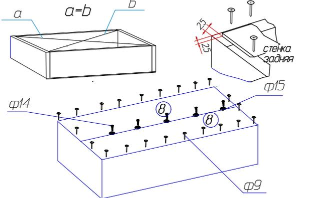
Начните сборку каркаса. Проверьте перпендикулярность и параллельность щитов и зафиксируйте с помощью задней стенки из ДВП, как указано на рисунке, не нарушая диагонали. Помните, что от этого зависит правильности работы выдвижных ящиков.
